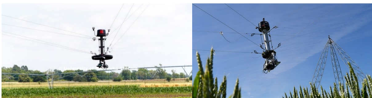
Figura 1.17 Cable robot in agricoltura: a sinistra compare l'impianto dell' University of Nebraska , a destra quella dell' ETH di Zurigo
