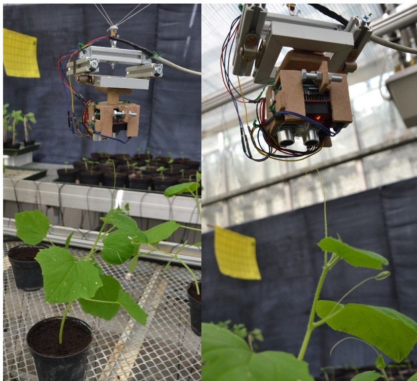
Figura 6.4 Dettaglio dell' end effector durante le scansioni in serra
