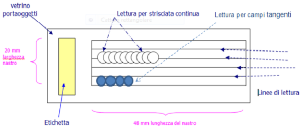
Figura 18: Rappresentazione grafica della struttura del vetrino e dei metodi di lettura. (ARPAT)
