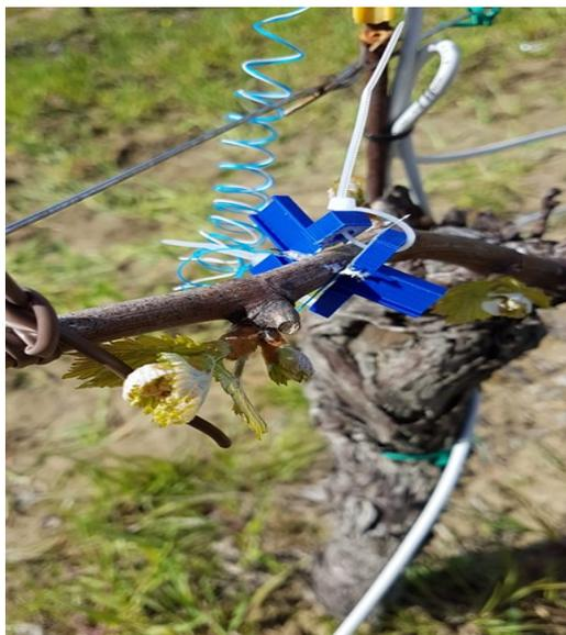
*Figura 4-4: Sensore Bioristor per misurazione del flusso linfatico (progetto Vitis, 2021)*
