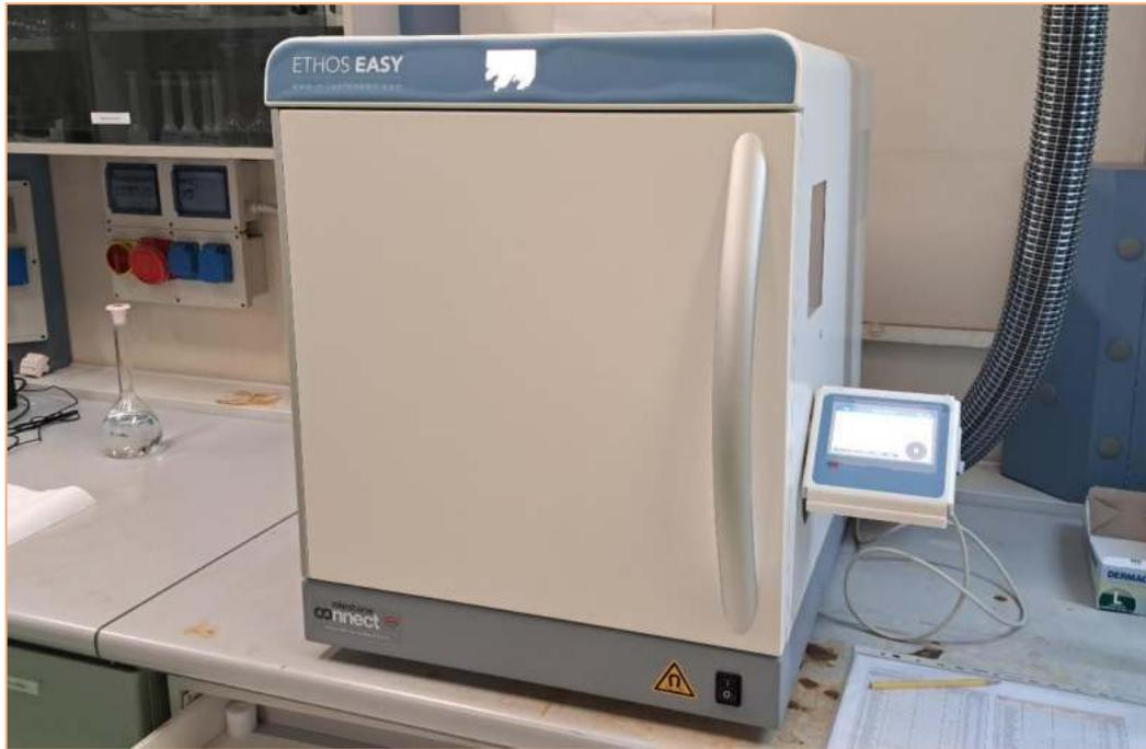
Figura 10: Mineralizzatore a microonde utilizzato per la mineralizzazione dei campioni.
