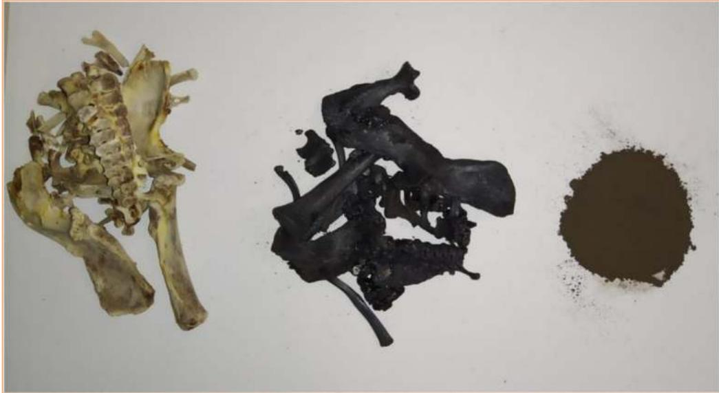
*Figura 2: Foto dei vari stadi di produzione delle nHAP<sub>300</sub>. Da sinistra verso destra: ossa di pollo pulite, ossa dopo il trattamento termico a 300°C, nanoparticelle dopo la macinazione al mulino a palle (Foto di Laura Pilotto).*
