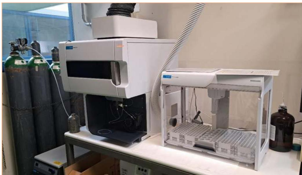
Figura 9: ICP-OES con autocampionatore utilizzato per le analisi.
