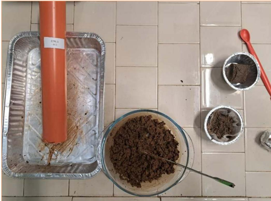
*Figura 7: Recupero del terreno della prima colonna Ctrl:MO<sub>-</sub>, con eliminazione della sabbia di drenaggio.*
