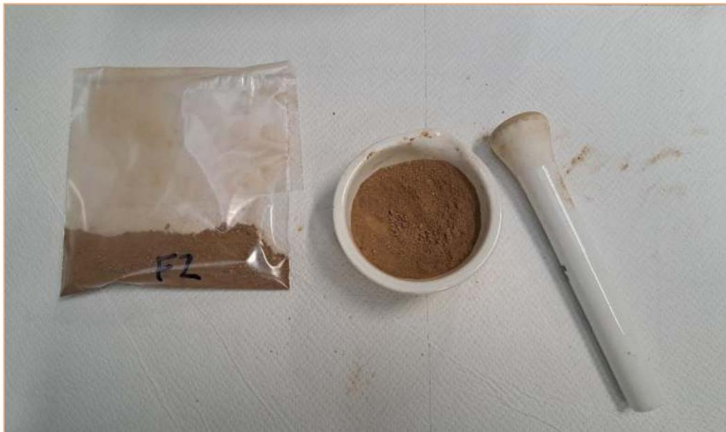
*Figura 8: Macinazione tramite pestello e mortaio del terreno essiccato all'aria della seconda replica di TSP:MO<sub>+</sub>.*
