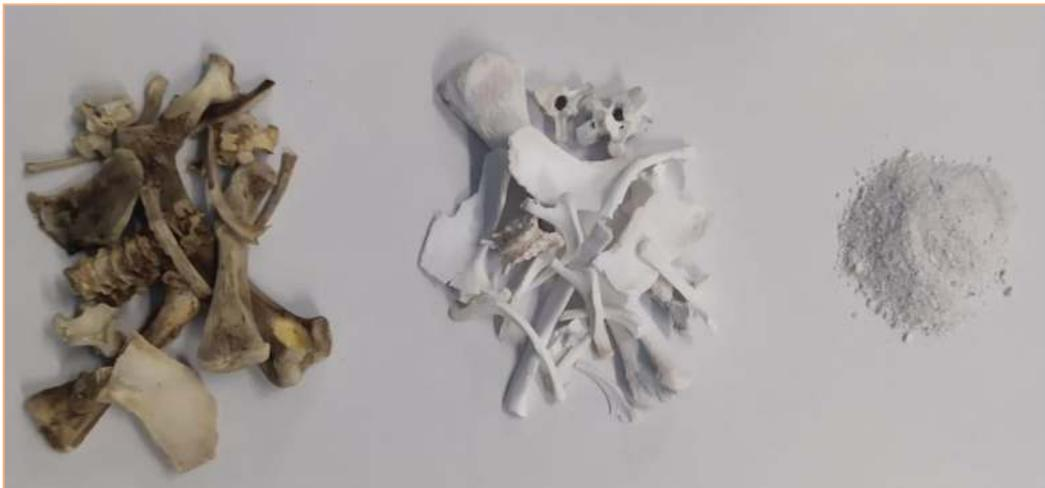
*Figura 3: Foto dei vari stadi di produzione delle nHAP<sub>700</sub>. Da sinistra verso destra: ossa di pollo pulite, ossa dopo il trattamento termico a 700°C, nanoparticelle dopo la macinazione al mulino a palle (Foto di Laura Pilotto).*
