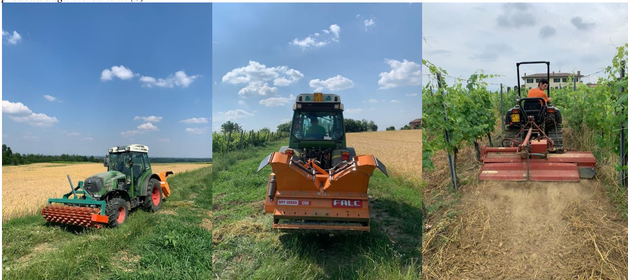
Foto 7 Macchine utilizzate per l'esecuzione delle terminazioni. A sinistra rullo (Eco-roll, Clemens) per l'esecuzione della pacciamatura mediante rullatura della biomassa degli inerbimenti (P), al centro trincia-andanatrice (Spit-green, Falc) per l'esecuzione della pacciamatura del sottofila con biomassa trinciata (A) e a destra vangatrice per la lavorazione del terreno nel controllo (Az) e per l'interramento della biomassa nel caso delle terminazioni che hanno previsto il sovescio della biomassa prodotta dagli inerbimenti (S)
