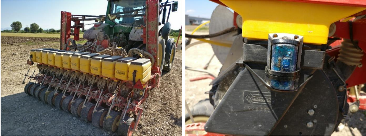
Figure 3.2 Seminatrice Matermacc MS4230 12 file e relativo posizionamento del sensore su uno degli elementi esterni
