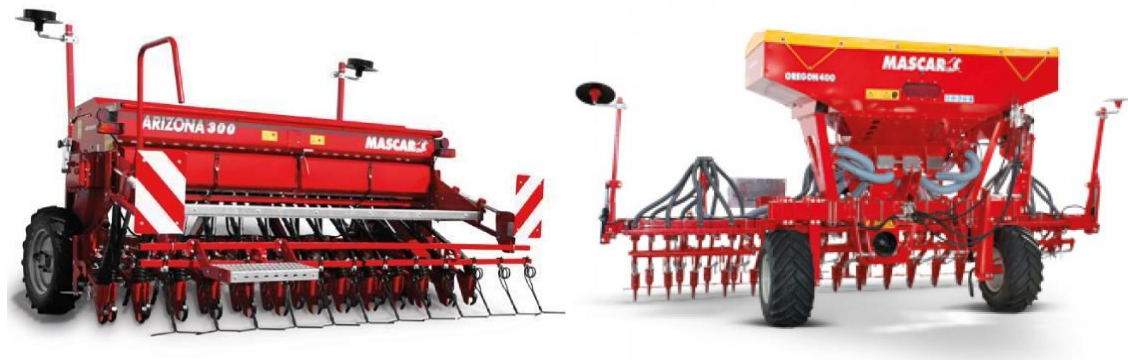
Figura 2.1 Esempio di seminatrice a righe a distribuzione meccanica con trasporto per gravità (sinistra) e con trasporto pneumatico (destra)
