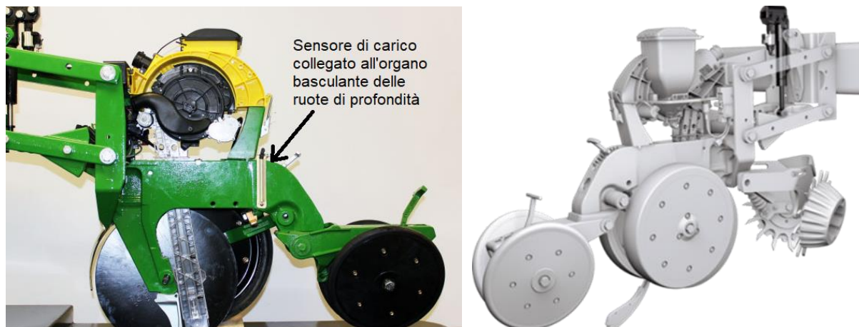
Figura 2.6 Posizione del sensore di carico del sistema Delta Force, e rappresentazione di montaggio del martinetto su sistema a parallelogramma.
