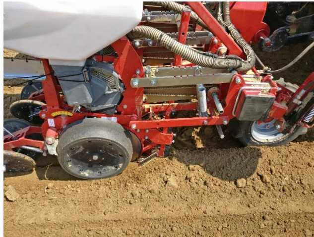
Figura 3.15 Seminatrice Mascar 6 file, si possono notare anche la posizione del sensore della fila esterna e le condizioni del letto di semina.
