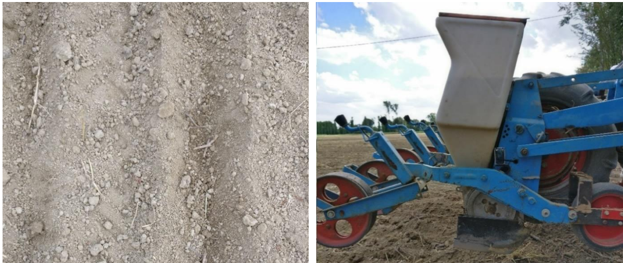
Figura 3.20 Condizioni terreno a sinistra e particolare dell'elemento di semina della Monosem 5 file a destra, con posizione di montaggio del sensore.
