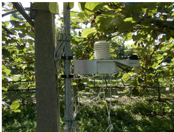
Figura - Posizionamento in condizioni non standard di una stazione agrometeorologica
