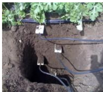
Figura - Posizionamento delle sonde suolo
