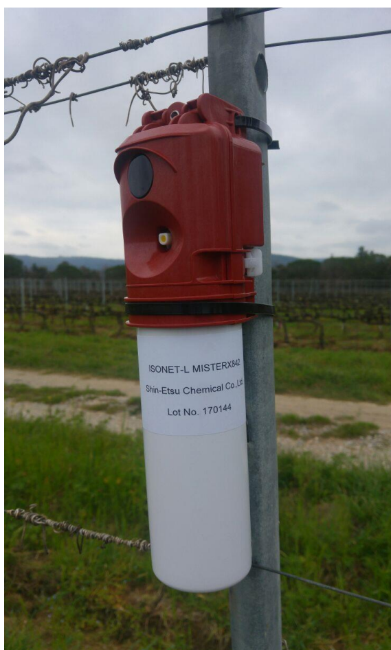
Figura 20- Centralina elettromeccanica Isonet L MisterMX841 (M. Zito)
