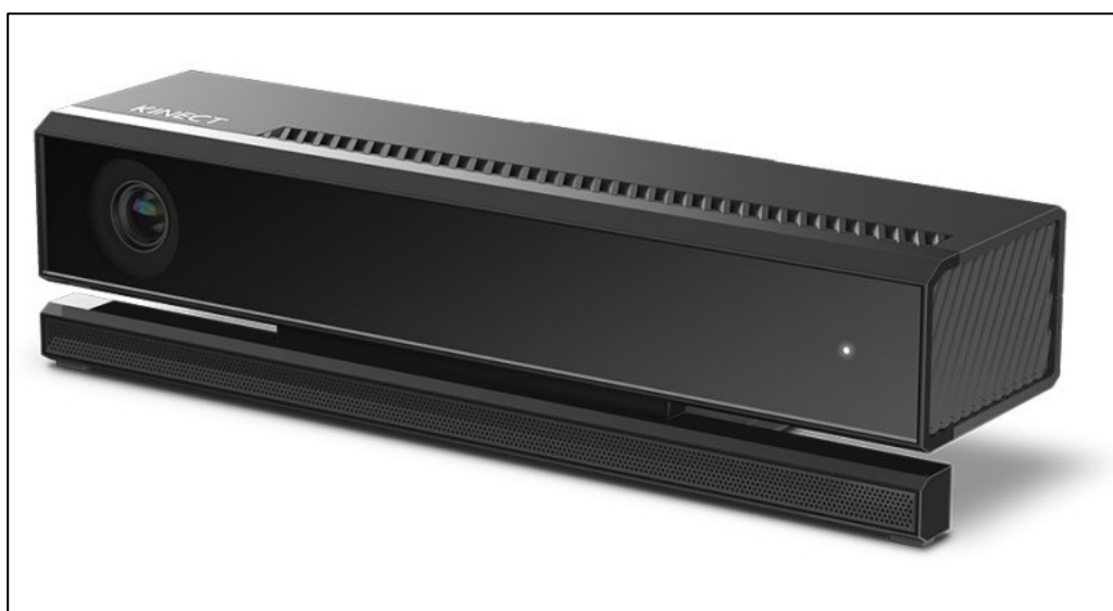
Figura 3: Dispositivo Microsoft Kinect V2 utilizzato per le sperimentazioni
