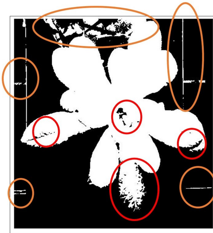
Figura 23: esempi di errori dell'analisi basata solamente sul colore: in Rosso le aree dove vi sono delle perdite dovute alle zone d'ombra, in arancione le aree in cui è stata compresa parte dello sfondo
