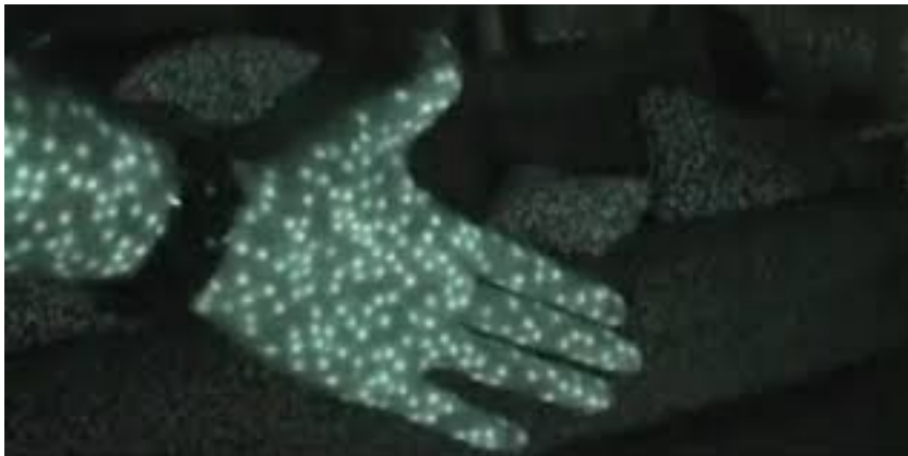
Figura 2: Sistema a luce strutturata: proiezione dei punti tramite Kinect V1
